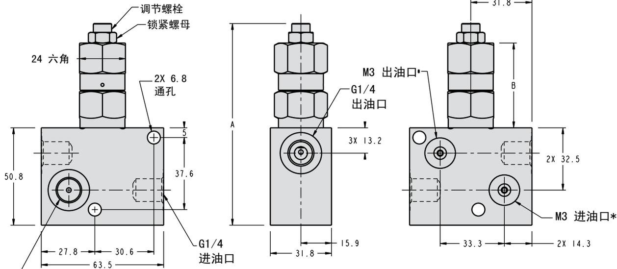
\*M3接口是用于板式安装应用中的O型圈沉孔
